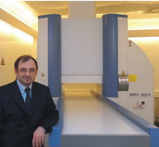
Auf diesem Gerät wird das Magnetfeld erzeugt, das die Eisenpartikel im Tumor erhitzt. The magnetic field which heats up the iron particles in the tumor is created with this system.
